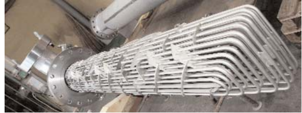
Abb. 5 Patentierter CSE-XR Mischer-Wärmetauscher von Fluitec für intensives Mischen bei gleichzeitig hoher Wärmeabfuhr.
